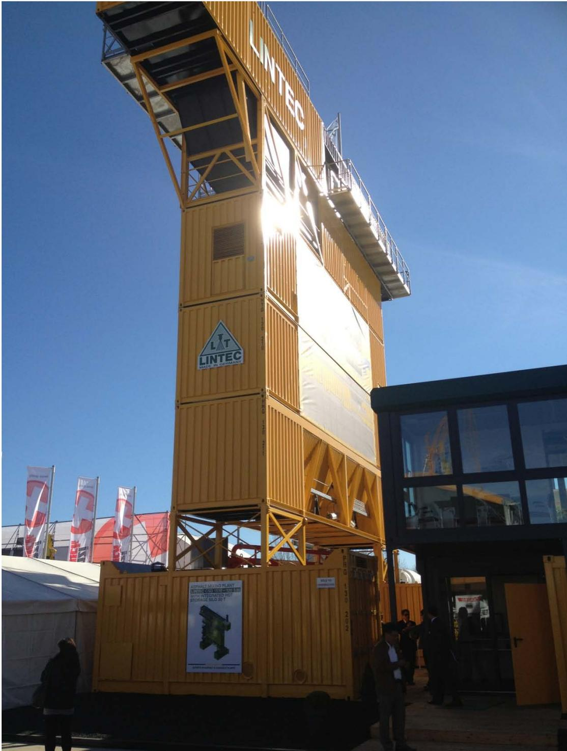
图 2: CSD1510 型沥青混凝土搅拌站
