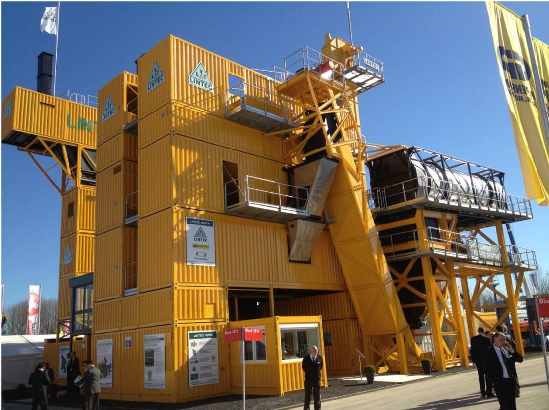
图 1：搭载了 HRC 冷热再生系统的林泰阁 CSM2500 型沥青混凝土搅拌站
